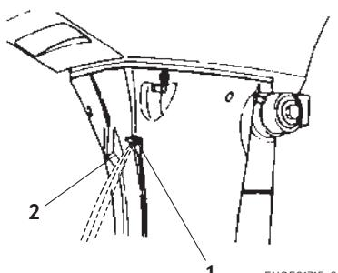
1. Контрольное отверстие для охлаждающей воды
